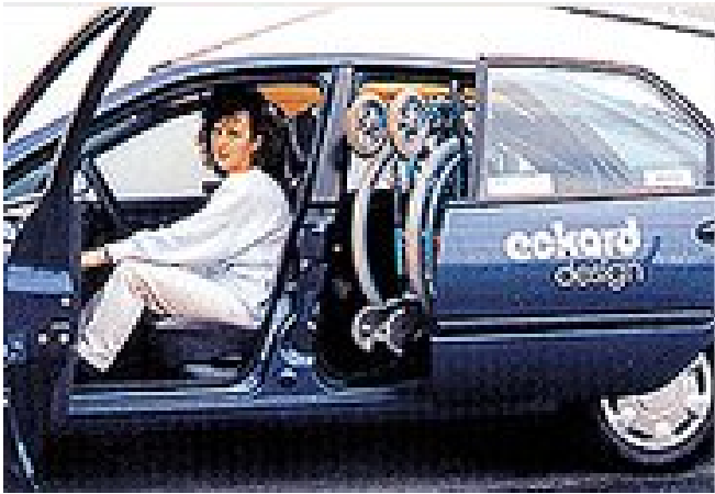
Schwenktür mit Rollstuhllift
